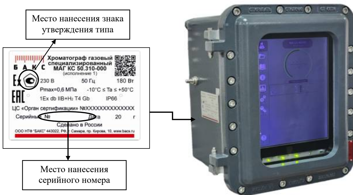
Рисунок 1 – Общий вид, место нанесения серийного номера и знака утверждения типа на хроматографы во взрывозащищенном исполнении (исполнение 1) с сенсорным ЖК дисплеем и панелью светодиодов
