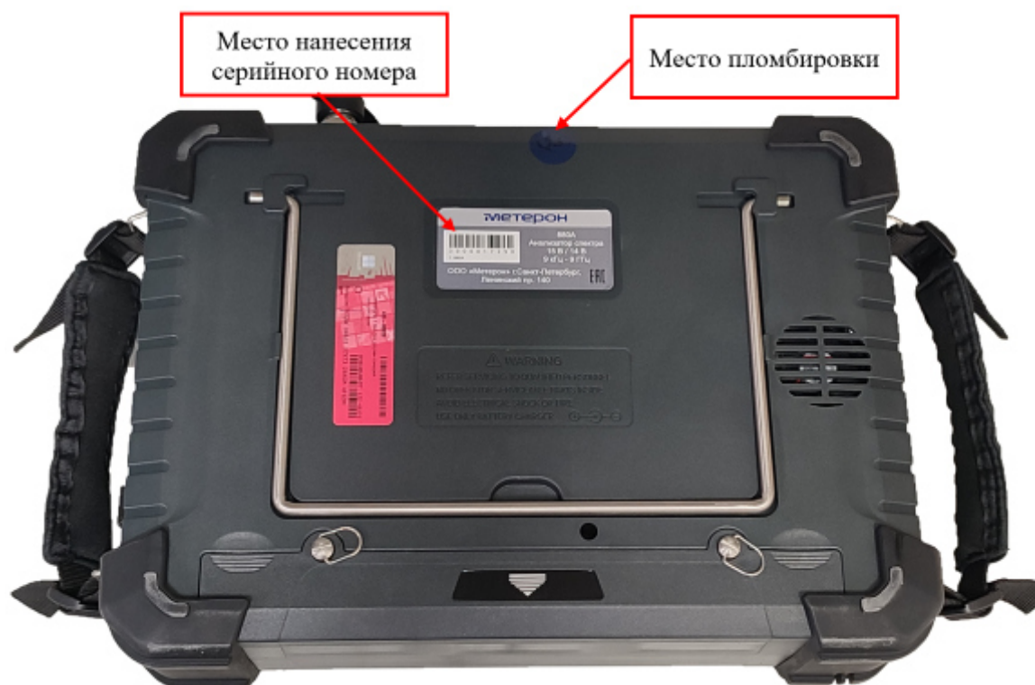
Рисунок 2 – Схема пломбировки и место нанесения серийного номера
