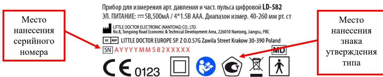
Рисунок 4 – общий вид маркировки, расположенной на обратной стороне корпуса электронного блока с указанием места нанесения серийного номера и знака утверждения типа
