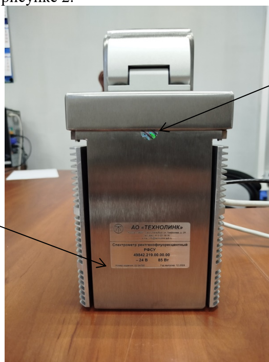
Рисунок 2 – Место пломбирования аналитического модуля и место нанесения заводского номера на аналитический модуль
