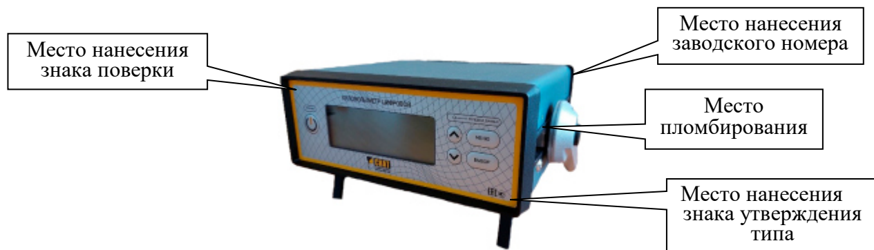
Рисунок 1 – Общий вид киловольтметров цифровых КВЦ модификаций КВЦ-10В-0,5; КВЦ-10В-0,25; КВЦ-10С-0,25 с указанием мест пломбировки от несанкционированного доступа, мест нанесения заводского номера, знака поверки и знака утверждения типа
