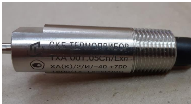
Рисунок 9 – Место нанесения знака утверждения типа методом лазерной гравировки на корпус преобразователя
