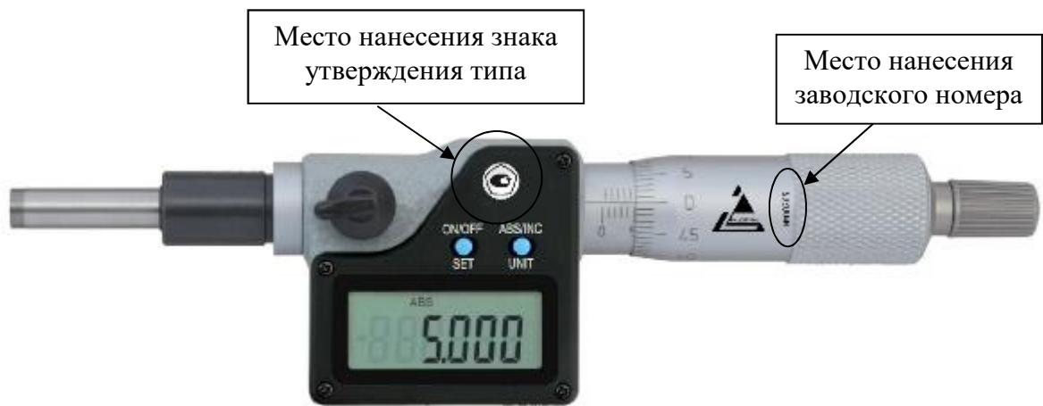
Рисунок 15 – Общий вид микрометров типа МГ с отсчетом показаний по электронному цифровому устройству, с указанием места нанесения заводского номера и знака утверждения типа
