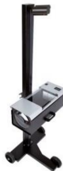
Рисунок 3 – Общий вид приборов для измерений параметров света фар автоотрапортных средств HL модификаций HL26D, HL26DLX, HL26DL2, HL26DL2LX
