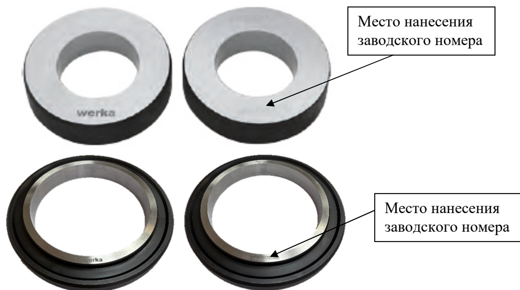
Рисунок 1 – Общий вид колец с указанием расположения заводского номера
