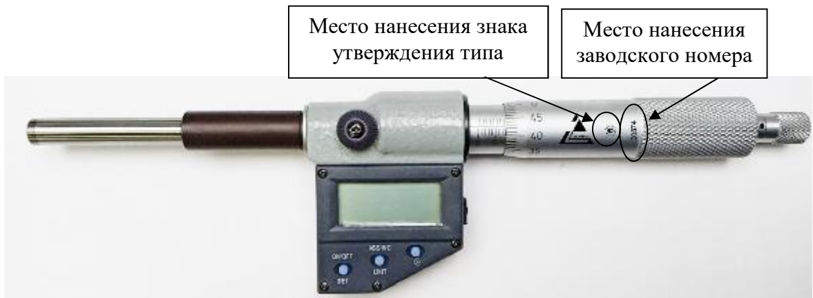
Рисунок 16 – Общий вид микрометров типа МГ с отсчетом показаний по электронному цифровому устройству, с указанием места нанесения заводского номера и знака утверждения типа
