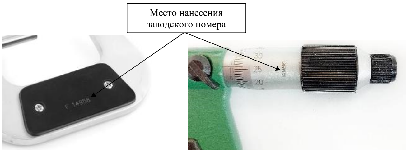
Рисунок 8 – Общий вид и место нанесения заводского номера
