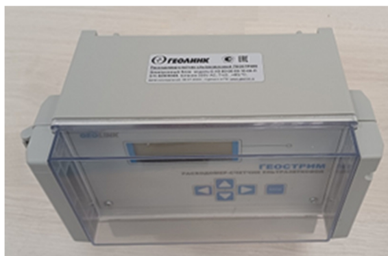
Рисунок 10 – Место крепления идентификационной наклейки на электронном блоке
