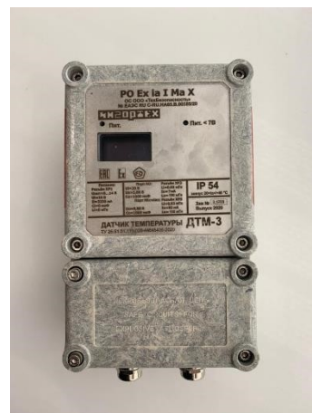
Рисунок 3 – Датчик температуры ДТМ исполнение ДТМ-3
