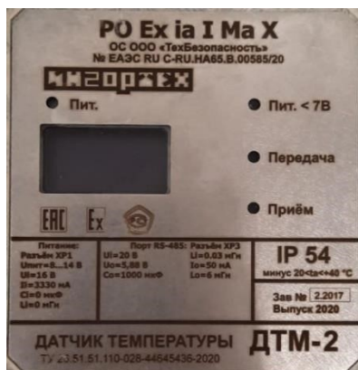
Рисунок 7 – Идентификационная табличка на корпусе датчиков
