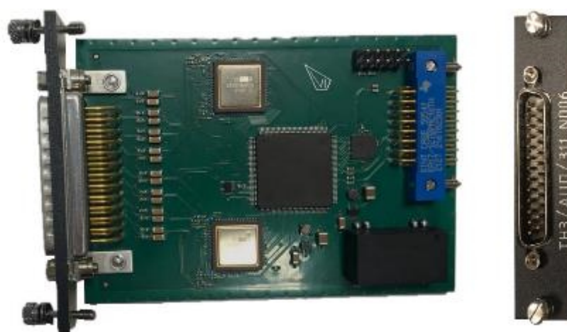
Рисунок 27 – Общий вид модуля ТНЗ/АЦП/311
