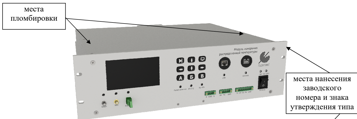
Рисунок 4 – Общий вид корпуса модулей в корпусе со степенью защиты IP42
