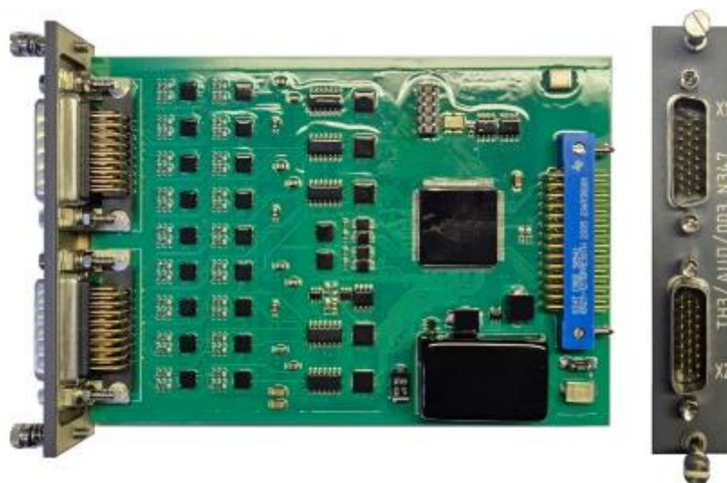
Рисунок 5 – Общий вид модуля ТНЗ/АЦП/003
