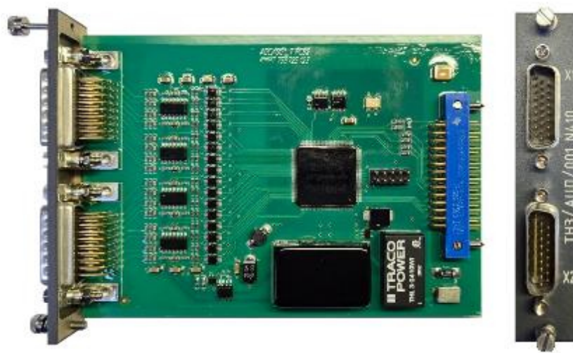
Рисунок 3 – Общий вид модуля ТНЗ/АЦП/001
