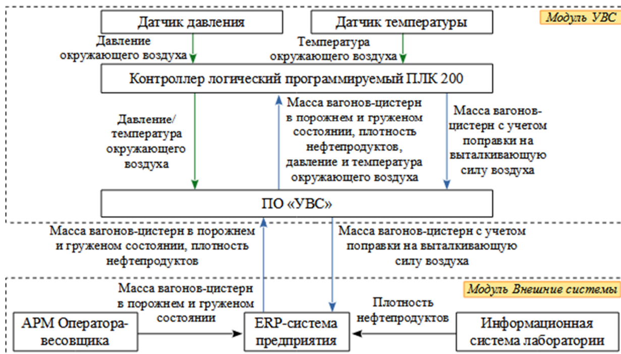
Рисунок 1 – Схема информационных потоков при выполнении измерений
