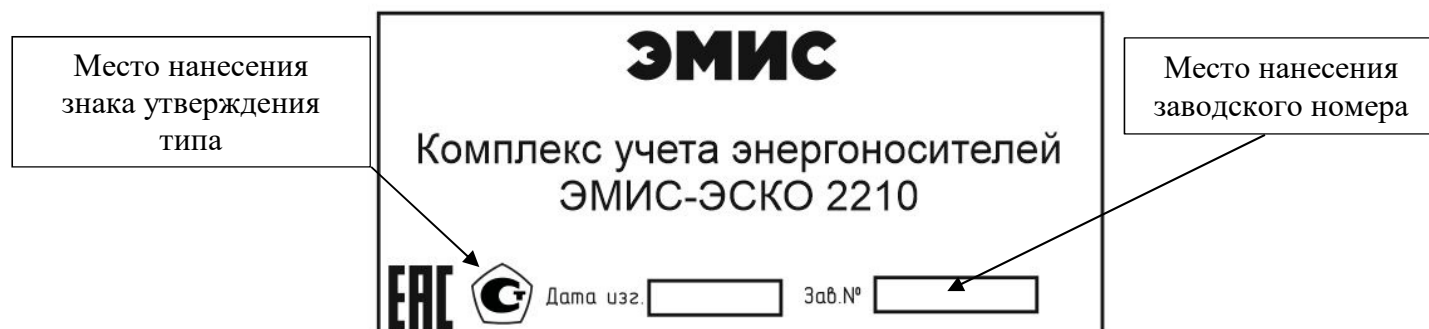
Рисунок 2 – Образец наклейки и места расположения заводского номера и знака утверждения типа комплекса
