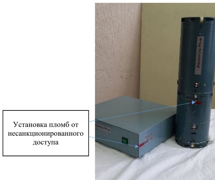
Рисунок 2 – Схема пломбирования от несанкционированного доступа
