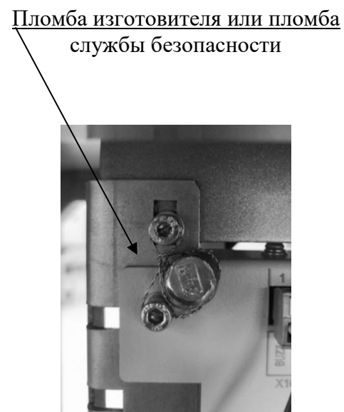
Рисунок 14 – Схема пломбировки узлов крепления блока управления
