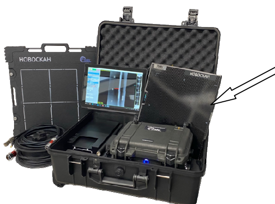
Рисунок 5 – Места нанесения серийного номера на системы цифровой радиографии Новоскан модификации Новоскан DR исполнений Новоскан DR П, Новоскан DR В, Новоскан DR Р, Новоскан DR Д
