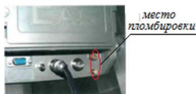
Рисунок 12 – Схема пломбировки прибора весоизмерительного CI-200A(S/SC)
