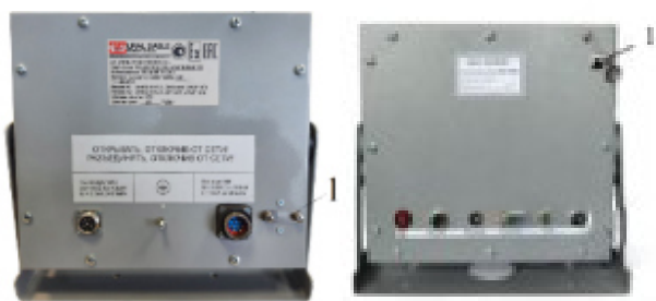
Рисунок 11 – Схема пломбировки приборов весоизмерительных KB-007KM (Ex), KB-007KM (1 – свинцовая, пластиковая или мастичная пломба)
