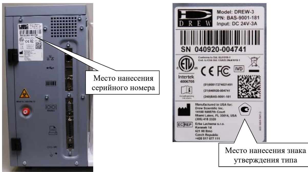
Рисунок 2 – Места нанесения серийного номера и знака утверждения типа
