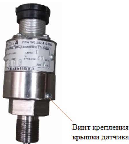
Рисунок 8 – Схема пломбирования преобразователей от несанкционированного доступа
