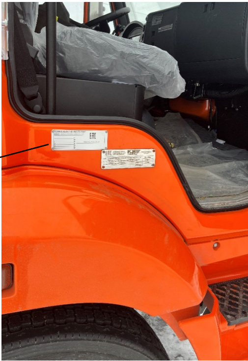
Рисунок 4 – Место нанесения заводского номера АЦ и АТЗ
