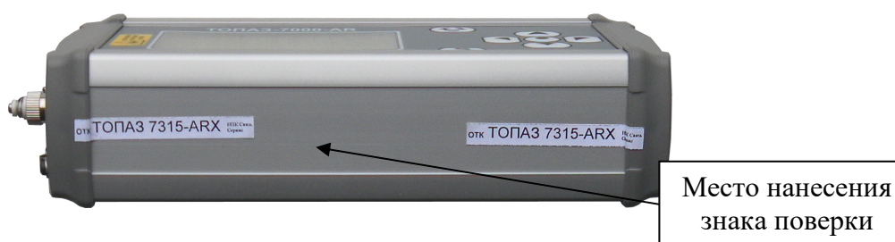
Рисунок 2 – Схема пломбировки тестеров от несанкционированного доступа, обозначение места нанесения знака поверки
