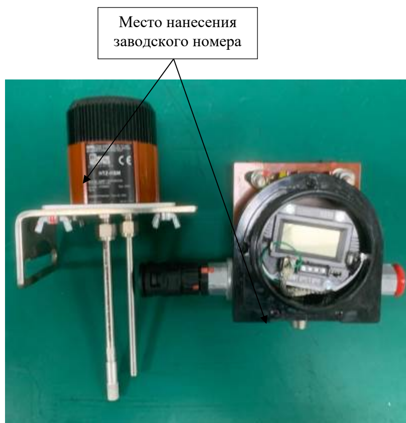
Рисунок 2 – Общий вид измерителей с указанием места нанесения заводского номера
