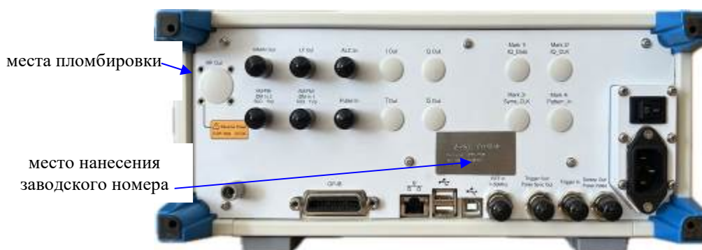
Рисунок 2 – Внешний вид генератора (вид сзади)
