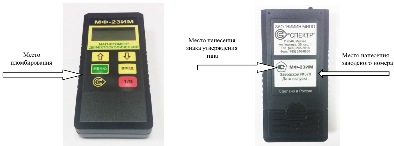
Рисунок 1 – Общий вид магнитометров, с указанием места пломбировки, знака утверждения типа и заводского номера
