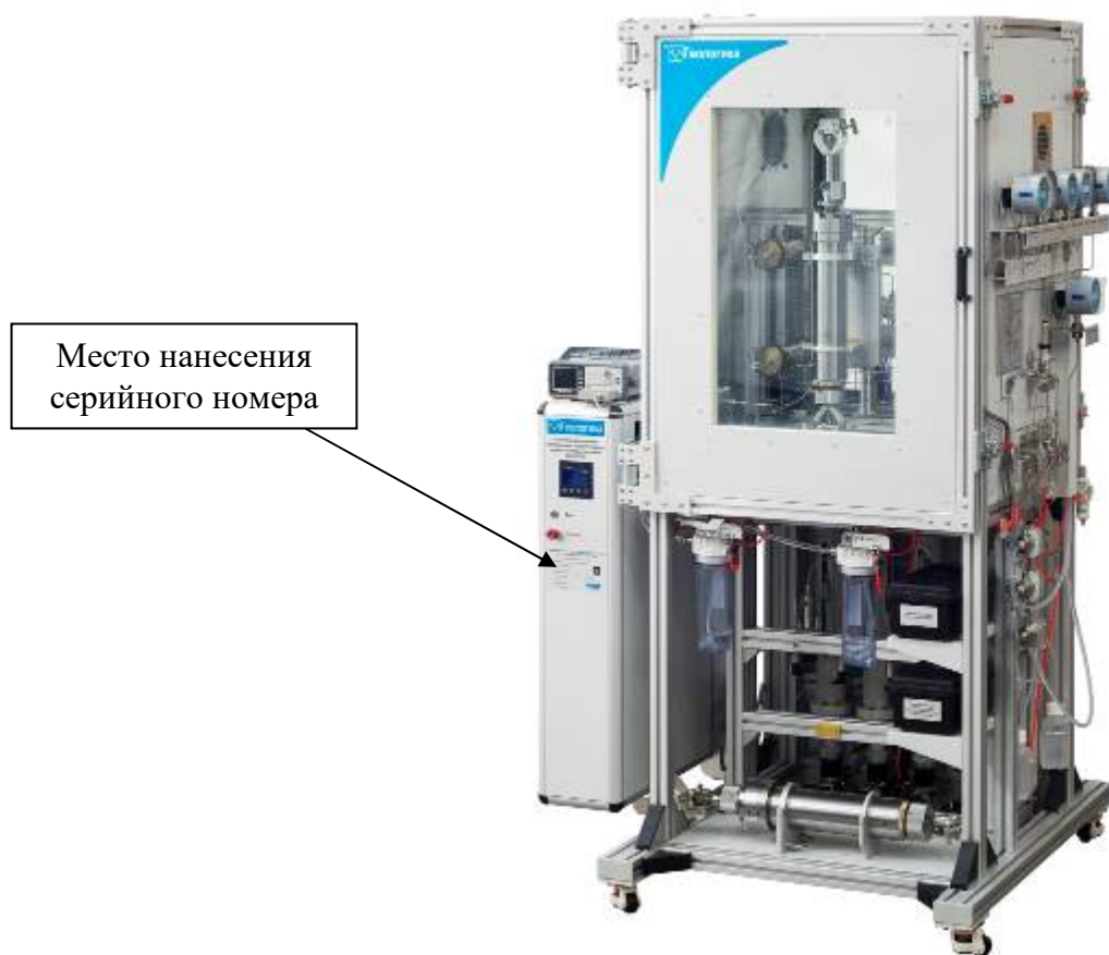
Рисунок 1 – Общий вид и место нанесения серийного номера на установки для изучения электрических и упругих свойств керна в пластовых условиях ПИК-УЗ-УЭС
