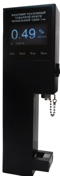
Рисунок 1 – Влагомер эталонный товарной нефти мобильный УДВН-1эм
