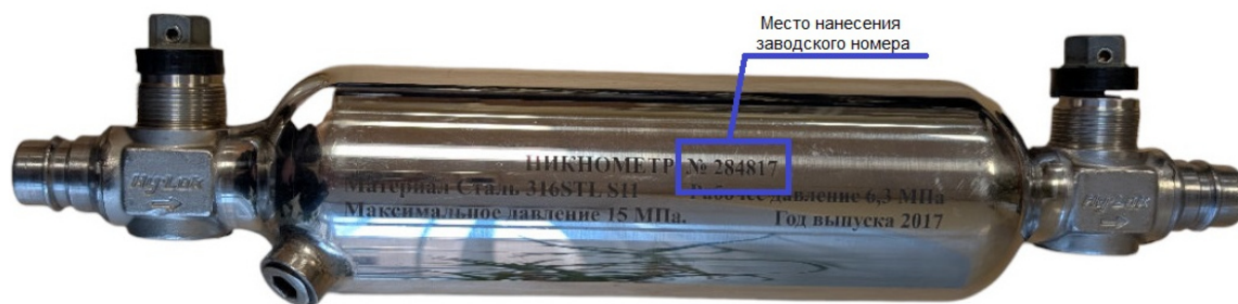
Рисунок 1 – Общий вид пикнометра с указанием места нанесения заводского номера
