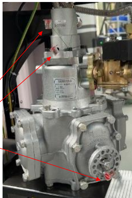
Рисунок 3 – Схема пломбировки и нанесение знака поверки
