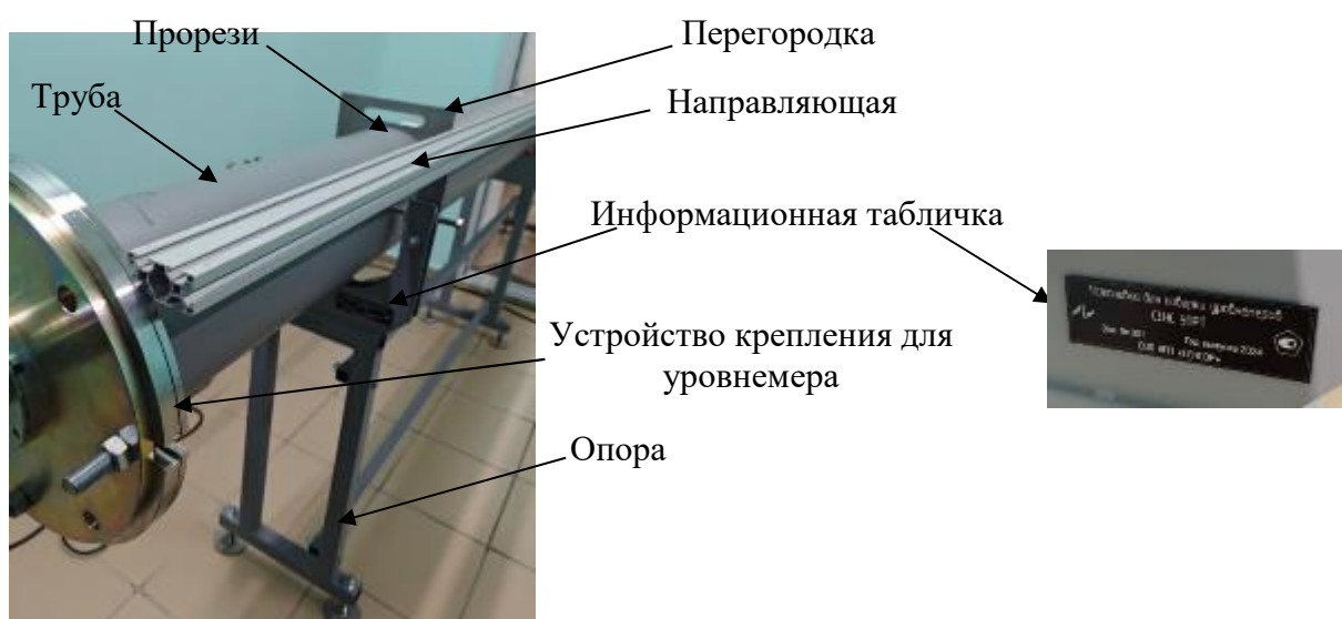
Рисунок 1 – Общий вид установки
