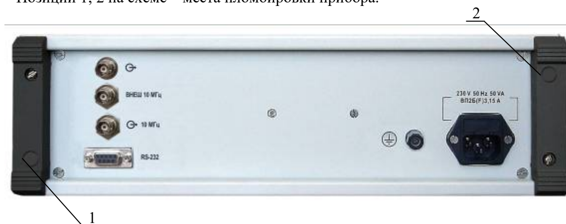
Рис. 2 Схема пломбировки прибора.
