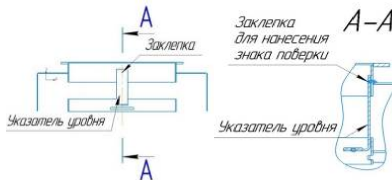
Рисунок 4 – Схема пломбировки от несанкционированного изменения положения указателя уровня налива в горловине цистерны, обозначение места нанесения знака проверки
