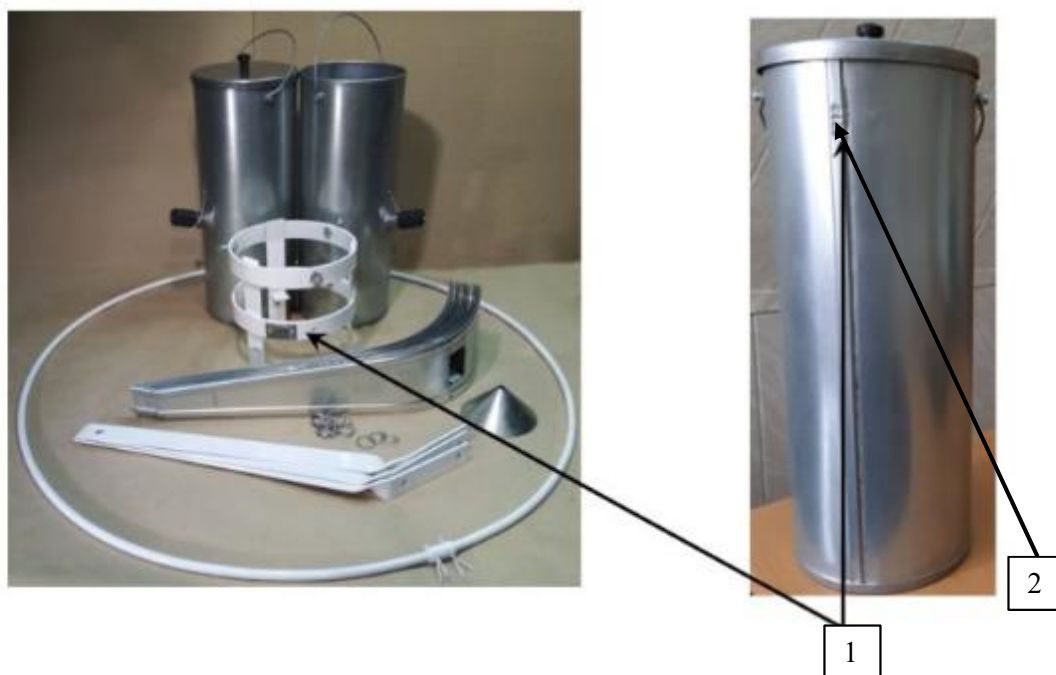
Рисунок 1 – Общий вид осадкомеров Третьякова О-1 с указанием составных частей, а также с указанием места нанесения заводского номера
