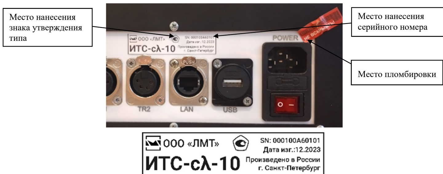
Рисунок 2 – Место нанесения знака утверждения типа, серийного номера и схема пломбировки прибора
