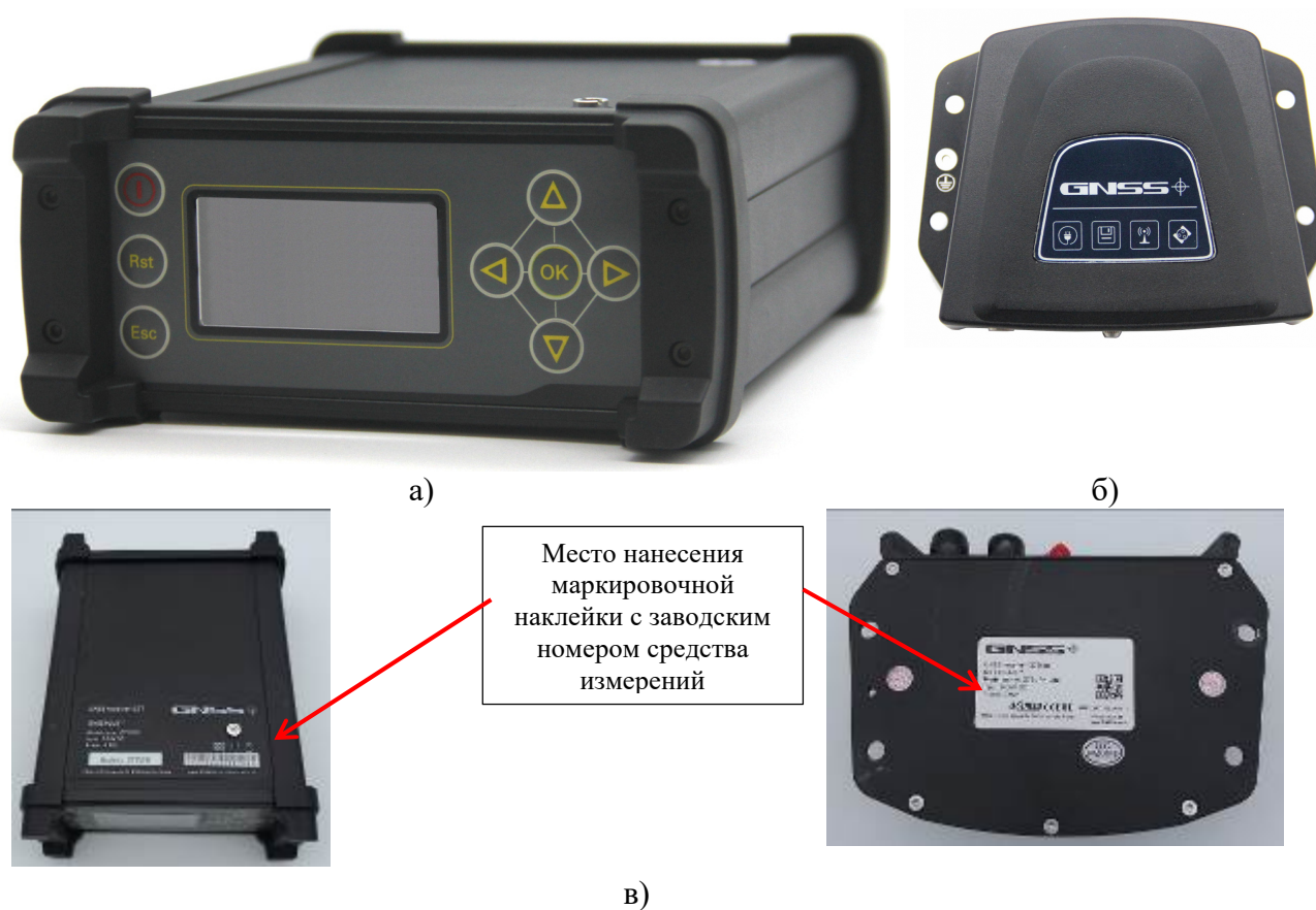
Рисунок 1 – Общий вид аппаратуры геодезической спутниковой GNSSPLUS G77 модификаций: а) G77UFH, G77UGH; б) G77UFH-Lite, G77UGH-Lite; в) место нанесения заводского номера средства измерений
