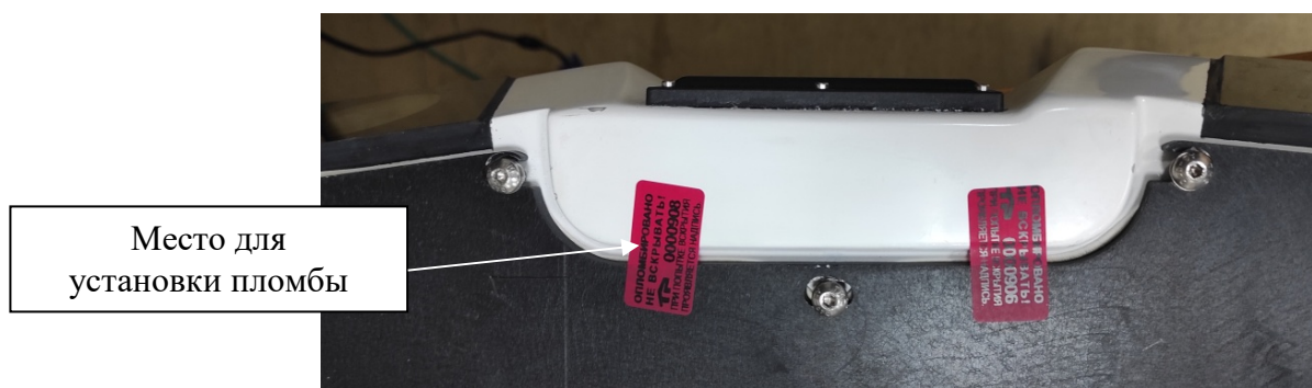
Рисунок 4 – Схема пломбировки от несанкционированного доступа на нижней поверхности видеомодуля
