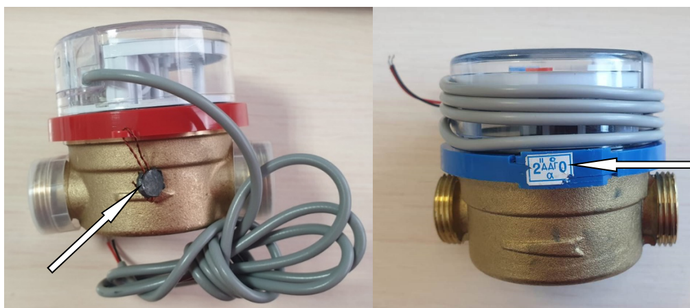
Рисунок 2 – Схема пломбировки от несанкционированного доступа, обозначение места нанесения знака поверки счетчиков
