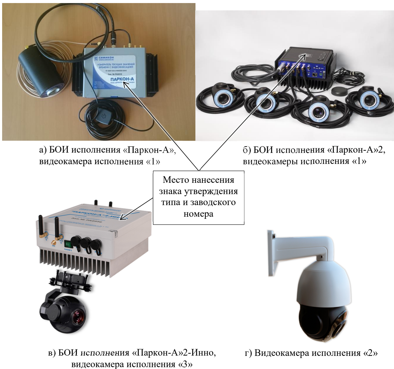
Рисунок 1 – Общий вид измерителей, места размещения знака утверждения типа и заводского номера
