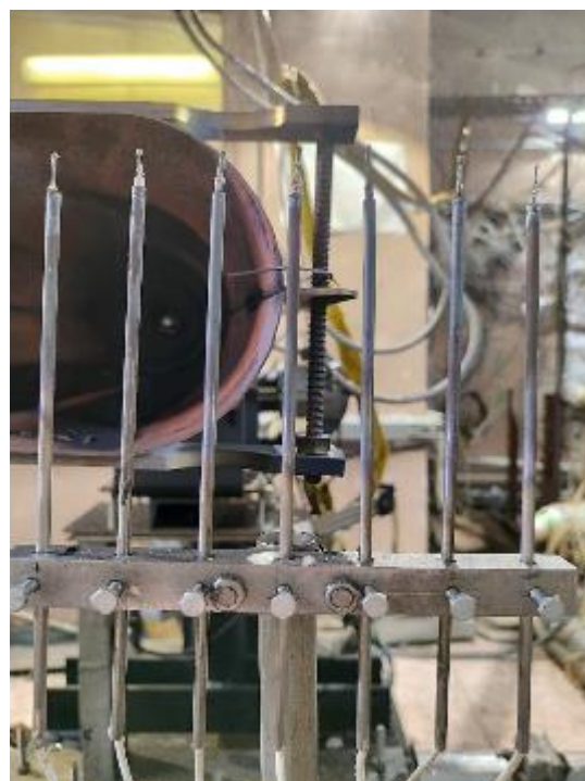
Рисунок 2 – Гребёнка с термоэлектрическими преобразователями ТХА (К), ТНН (N)
