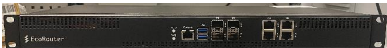
Рисунок 6 – Оборудование коммутации и маршрутизации пакетов информации сетей передачи данных EcoRouter. Модификация ER-T406. Лицевая панель
