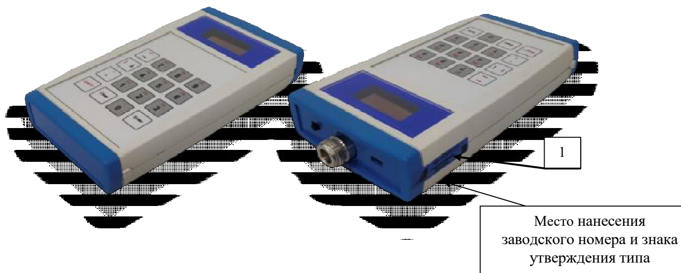
Рисунок 1 – Общий вид ВПМ, обозначение места пломбировки от несанкционированного доступа, а так же место нанесения заводского номера и знака утверждения типа
