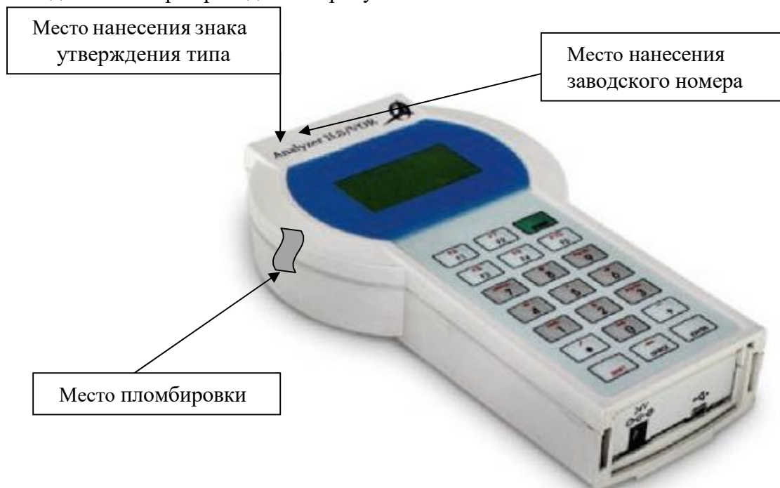
Рисунок 1 - Внешний вид анализатора, а также место нанесения знака утверждения типа и заводского номера
