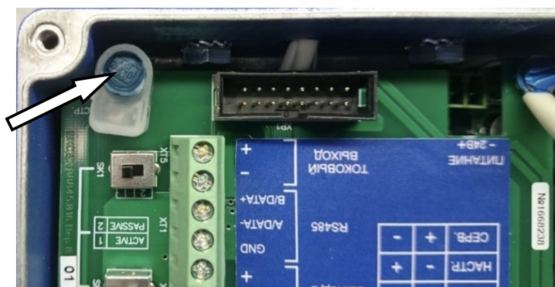
Рисунок 2 – Схема пломбировки от несанкционированного доступа, обозначение места нанесения знака поверки расходомеров-счетчиков электромагнитных «ВЗЛЕТ ЭМ»
