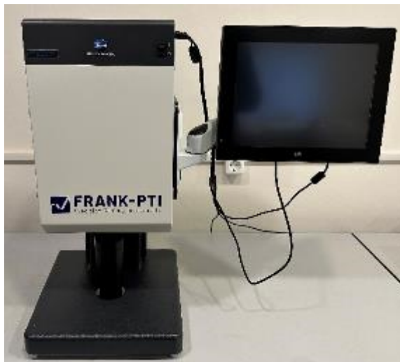
Рисунок 1 – Общий вид спектрофотометров FRANK-PTI S40606 0000
