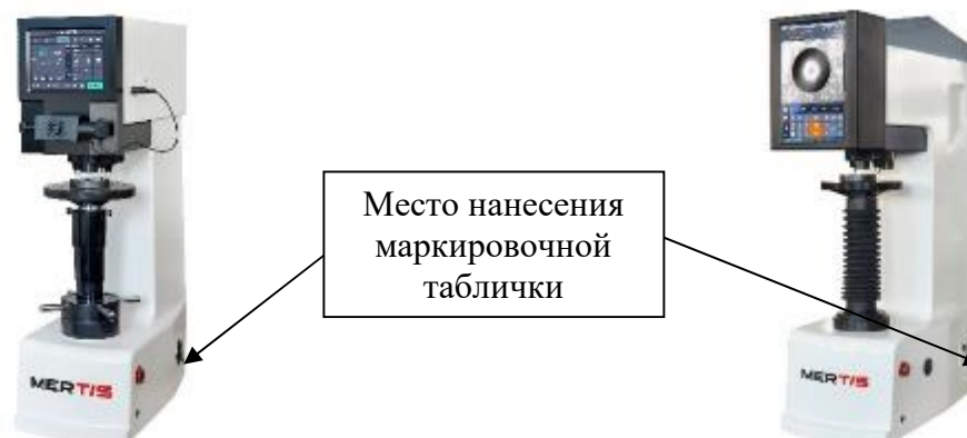
Рисунок 7 – Общий вид твердомеров Бринелля MERTIS XHB-3000Z-TS
