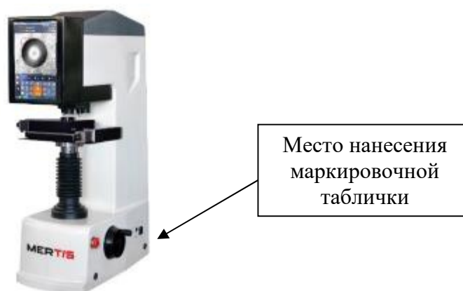
Рисунок 9 – Общий вид твердомеров Бринелля MERTIS XHBT-3000Z III/V3.0
