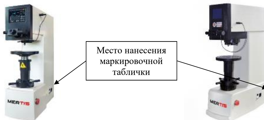
Рисунок 5 – Общий вид твердомеров Бринелля MERTIS XHB-3000-TS
