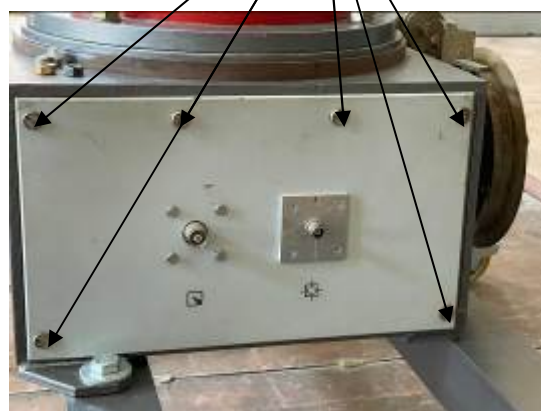
Рисунок 1 – Общий вид делителя с обозначением места пломбирования и места нанесения заводского номера
