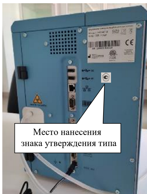
Рисунок 2 – Места нанесения заводского номера и знака утверждения типа
