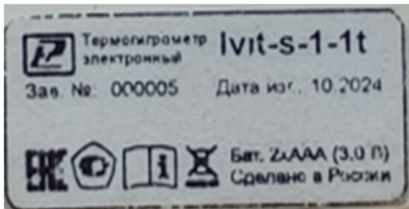
Рисунок 2 – Пример наклейки с заводским номером и знаком утверждения типа
