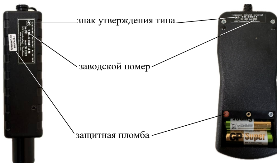
Рисунок 2 – Места нанесения заводского номера, знака утверждения типа и пломбирования от несанкционированного доступа
