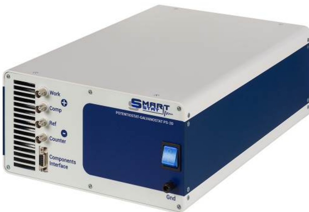
Рисунок 3 – Общий вид потенциостатов-гальваностатов PS-20
