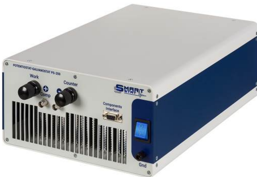
Рисунок 9 – Общий вид потенциостатов-гальваностатов PS-250
