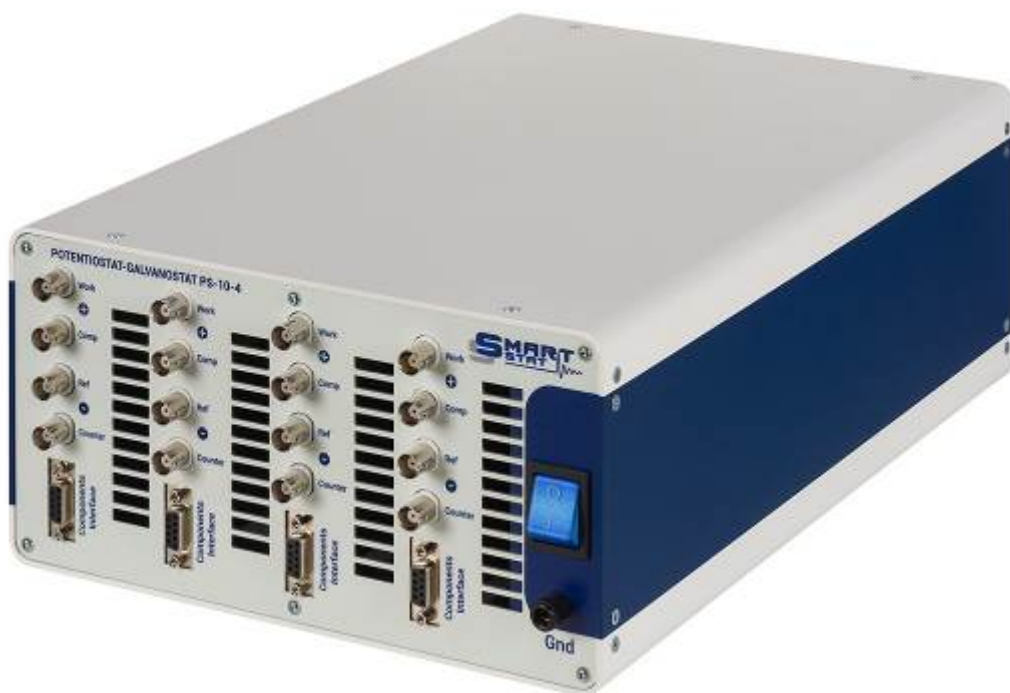
Рисунок 2 – Общий вид потенциостатов-гальваностатов PS-10-4
