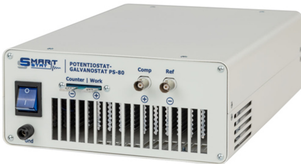
Рисунок 8 – Общий вид потенциостатов-гальваностатов PS-80
