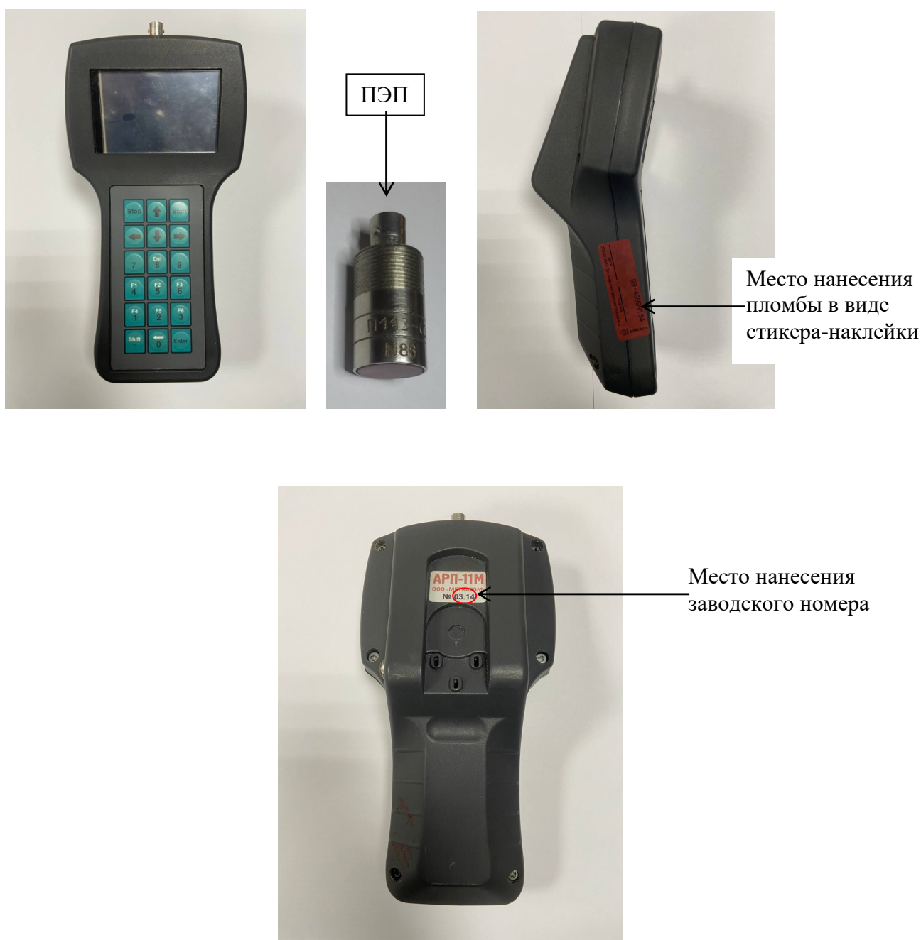
Рисунок 2 – Внешний вид измерителя амплитуд сигналов акустической эмиссии для диагностики и анализа ресурса редукторов и подшипников типа АРП-11/М с указанием места нанесения пломбы в виде стикера-наклейки и места нанесения заводского номера
