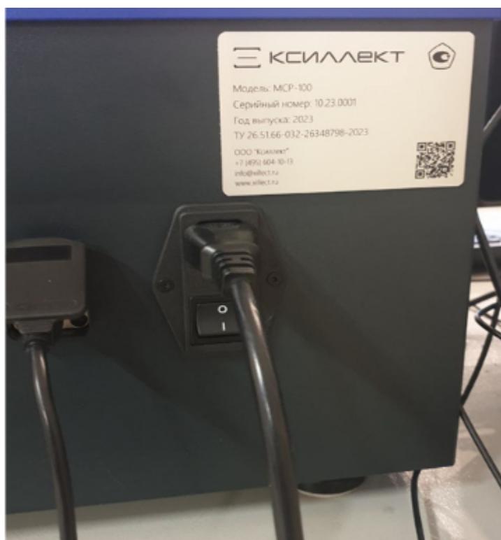
Рисунок 2 – Вид маркировочной таблички и место ее нанесения на приборы
