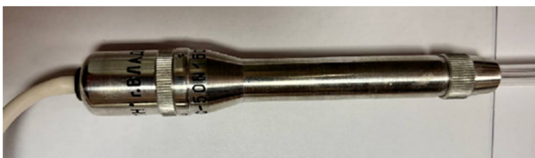
Рисунок 2 – Место нанесения заводского номера
