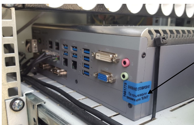
Рисунок 3 – Схема пломбировки от несанкционированного доступа модуля обработки и управления
