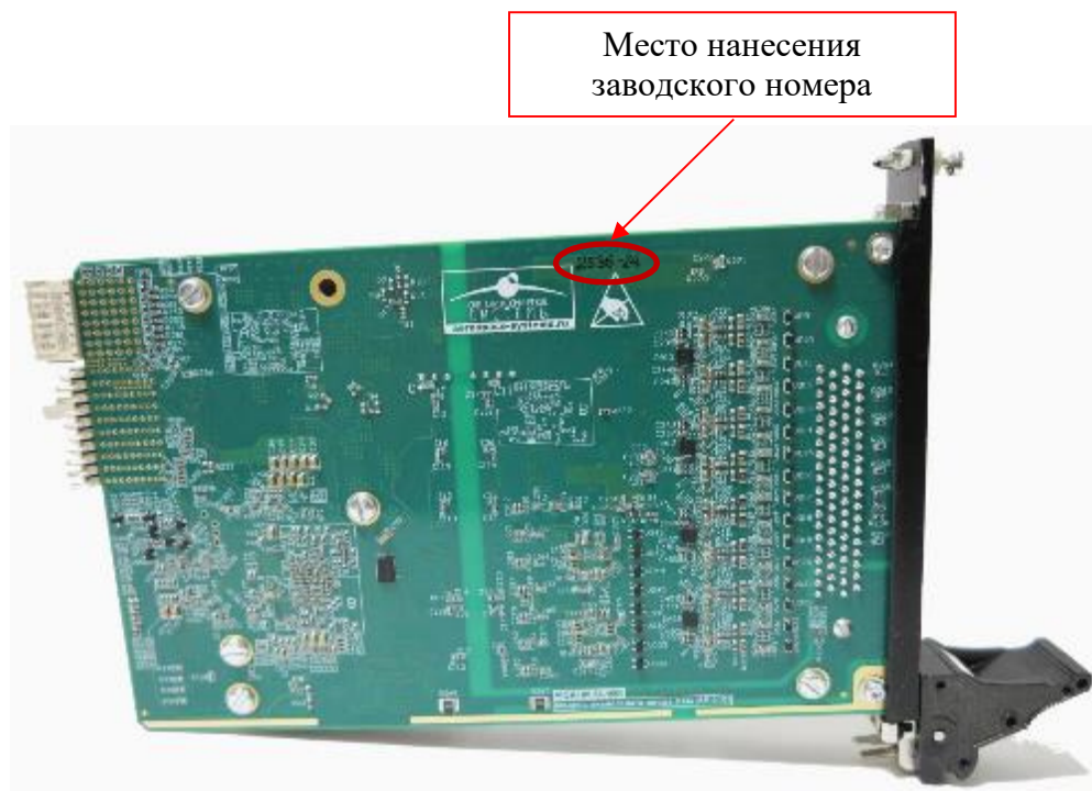
Рисунок 3 – Модуль MP-0101 с местом нанесения заводского номера
