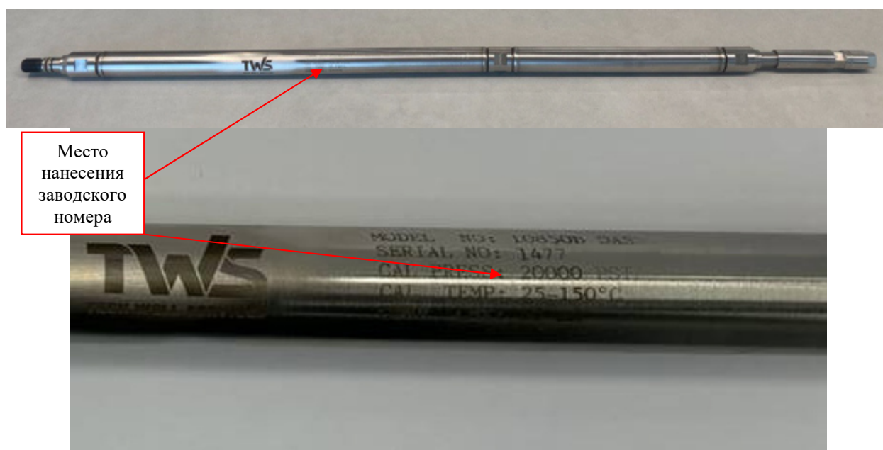
Рисунок 2 – Общий вид термометра-манометра скважинного. Обозначение места нанесения заводского номера
