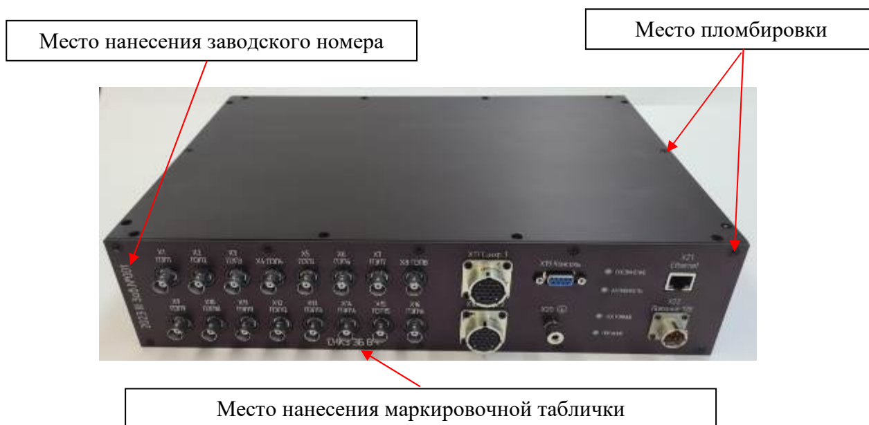
Рисунок 1 – Общий вид дефектоскопа с указанием мест пломбировки, места нанесения заводского номера и маркировочной таблички
