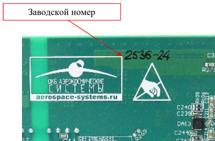
Рисунок 3 – Модуль MP-0101 с местом нанесения заводского номера
