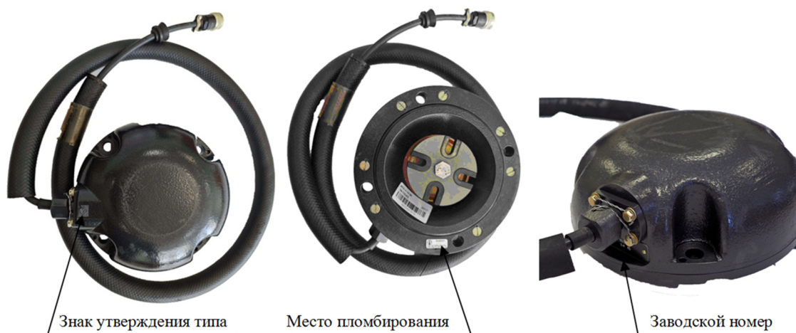
Рисунок 4 – Общий вид датчиков ДПС-У-14.01, ДПС-У-14.02, ДПС-У-14.03, ДПС-У-14.04, ДПС-У-14.05, ДПС-У-14.06, ДПС-У-14.07, ДПС-У-14.08 с указанием места нанесения заводского номера, знака утверждения типа и места пломбирования
