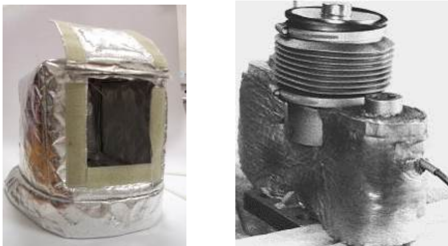
Рисунок 1 – Весоизмерительный датчик оснащенный термочехлом
