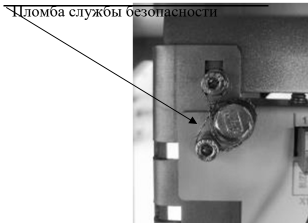
Рисунок 15 – Схема пломбировки узлов крепления БУ
