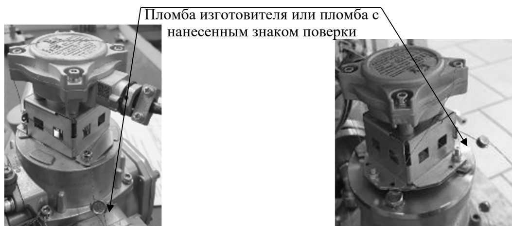
Рисунок 12 – Схемы пломбировки генераторов импульсов
