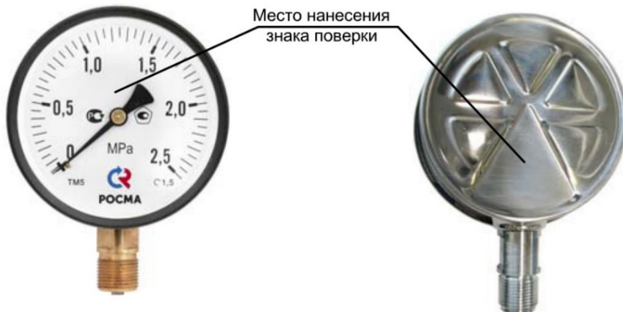
Рисунок 14 – Обозначение места нанесения знака поверки
