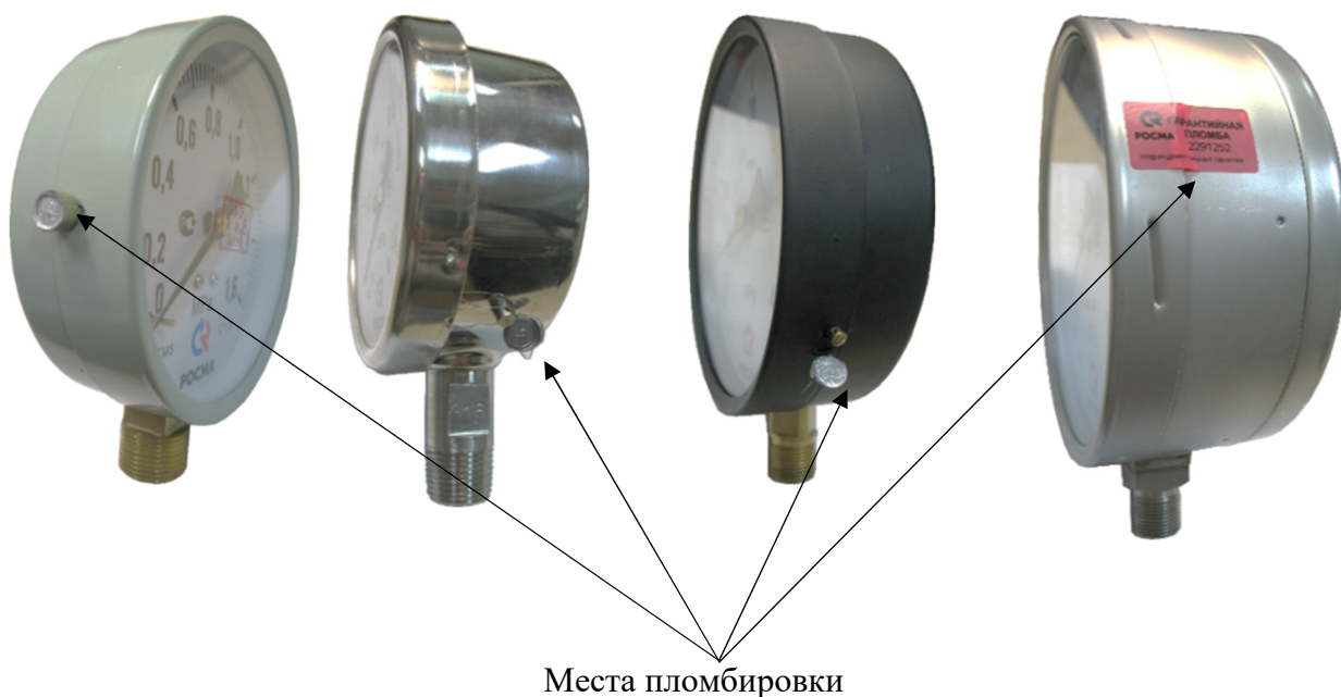
Рисунок 13 – Схемы пломбировки приборов от несанкционированного доступа
