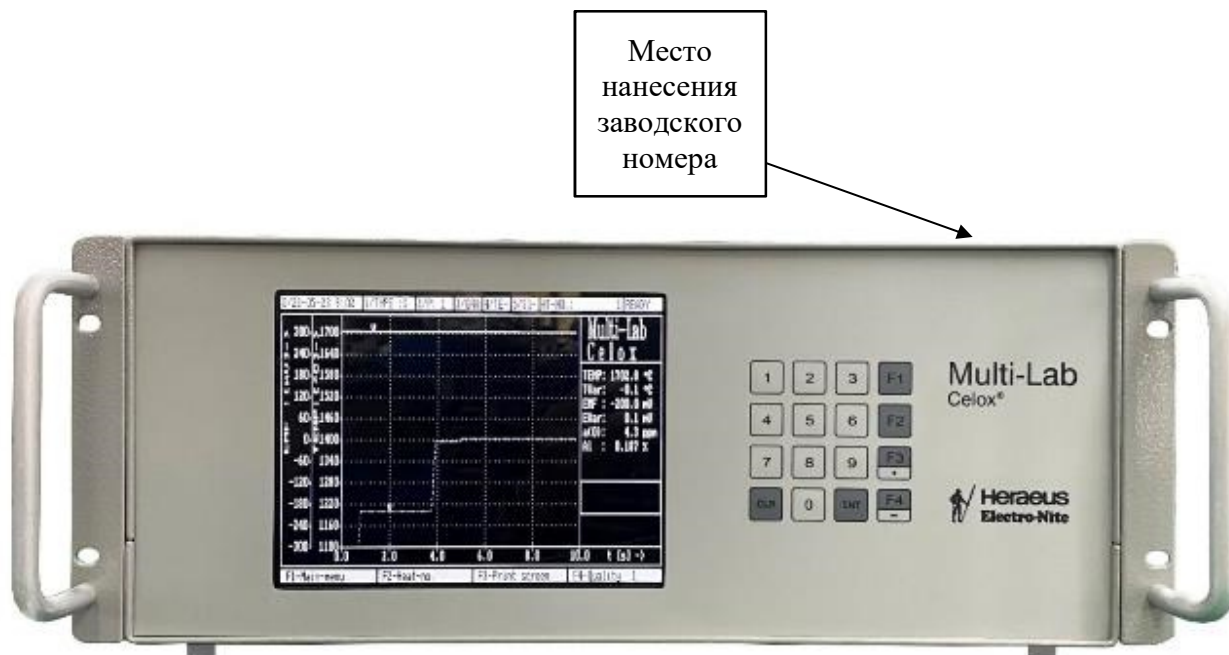
Рисунок 1 – Внешний вид приборов multifunctional для измерения параметров жидких металлов ML2C-CELOX
