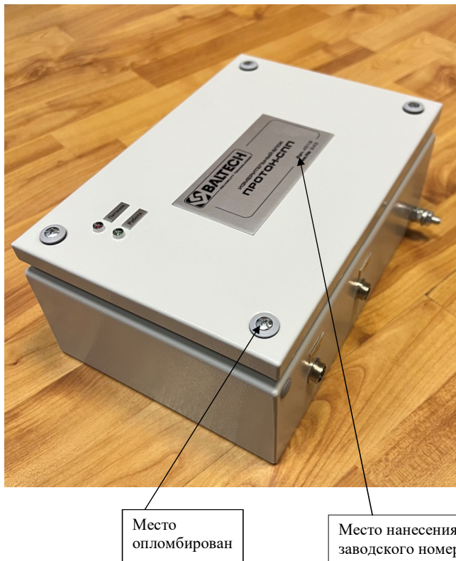
Рисунок 1 – Общий вид измерительного блока виброанализаторов «ПРОТОН-СПП»
