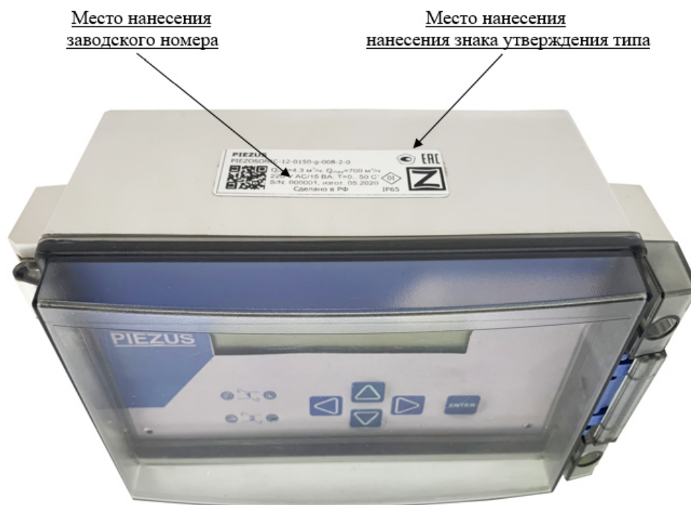
Рисунок 3 – Схема пломбировки от несанкционированного доступа и обозначение места нанесения знака поверки
