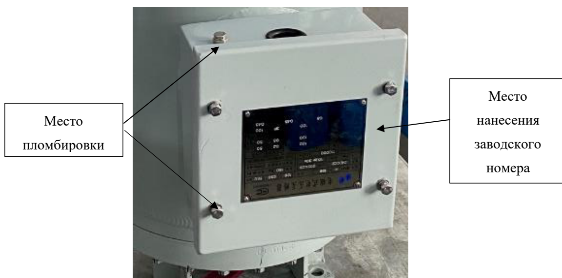
Рисунок 2 – Место нанесения заводского номера и место пломбировки от несанкционированного доступа
