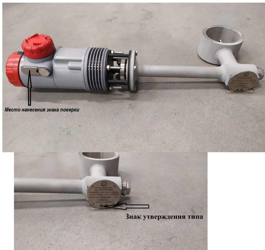
Рисунок 2 – Схема пломбировки от несанкционированного доступа, обозначение мест для нанесения знака поверки и знака утверждения типа
