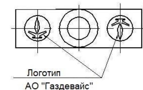
Рисунок 7 – Пломбирование от несанкционированного доступа, обозначение мест нанесения логотипа АО «Газдевайс». Обратная сторона пломбы
