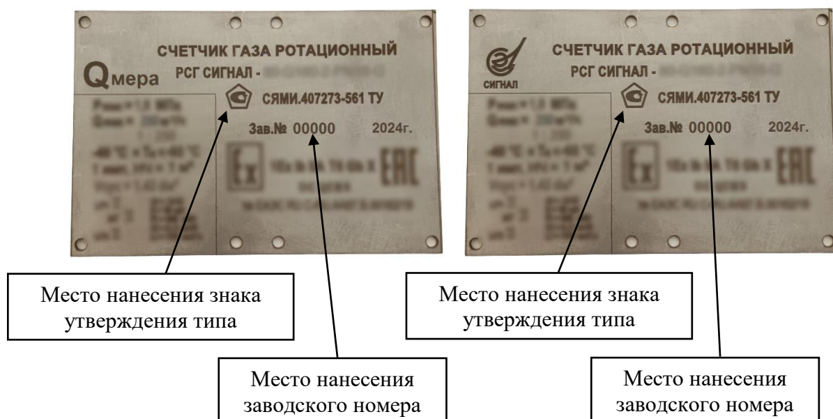
Рисунок 3 – Общий вид информационной таблички счетчиков исполнений Lite и Gray
