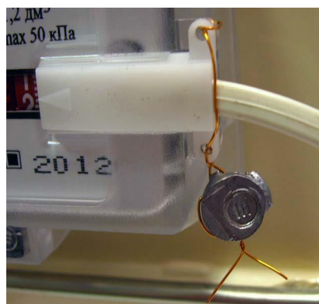
Рисунок 4 – Схема пломбировки датчика импульсов счетчиков в исполнении ГАЗДЕВАЙС
