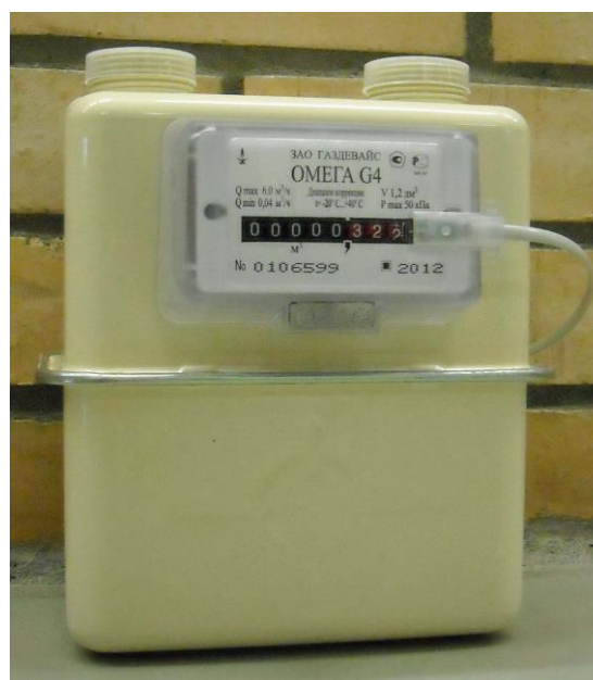
Рисунок 2 – Общий вид счетчика ОМЕГА-Т с датчиком импульсов в исполнении ГАЗДЕВАЙС
